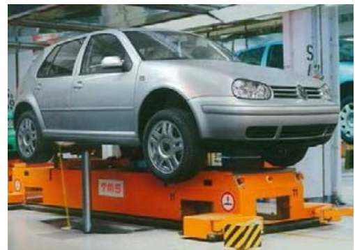
Aplikácia AVG transportného systému pri finalizácii automobilov podľa www.tms-automotion.com
