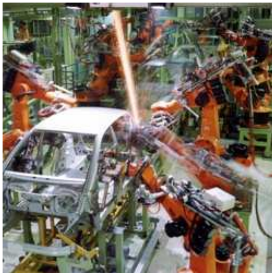
Obr. 6.25 Aplikácia priemyselných robotov Kuka pri stavbe karosérie automobilu Mercedes triedy A Benz vo firme DaimlerChrysler [47]
