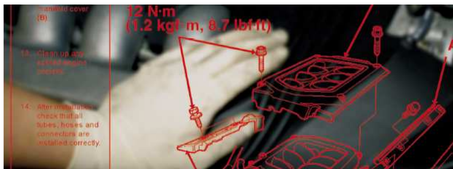
Obr. 5.3 Ukážka činnosti expertného technického systému NOMAD od firmy Microvision [69]
