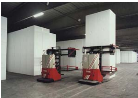
Vozidlo firmy TMS Automotion GmbH, LinzRakúsko so špeciálnym zverákovým chápadlom http://de.wikipedia.org/w/index.php?title=Datei:FTF_mit_Klammergereifer.JPG&filetimestamp=20060714172546
