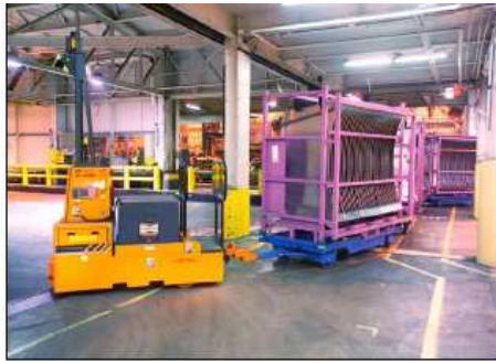
Aplikácia laserom navádzaného automatického ŕahača firmy FMC Technologies vo firme Ford podľa http://www.fmcsvgs.com
