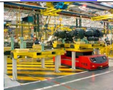
Zásobovanie montážnej linky pomocou AVG vozidiel podľa www.tms-automotion.com
