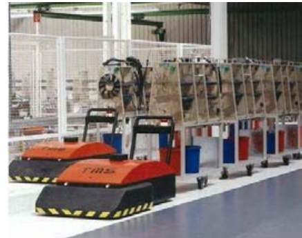
Transportný systém "Caddie Cart" –ŕahač s paletami a nádobami pre zásobovanie pracovísk drobnými súčiastkami podľa www.tms-automotion.com
