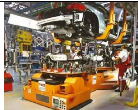
AVG systém na pracovisku „svadby“ pre športové vozidlá podľa www.tms-automotion.com
