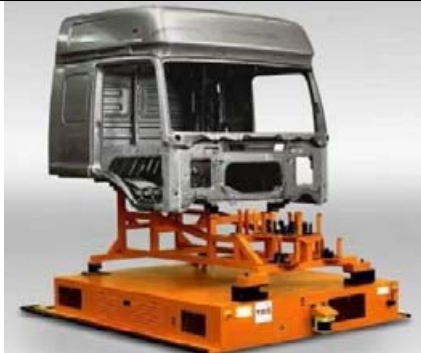
AVG vozidlo pre transport kabíny vodiča podľa www.tms-automotion.com
