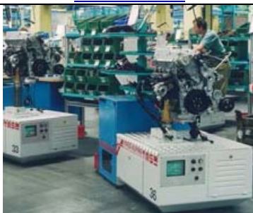
AVG pri montáži motorov podľa www.tms-automotion.com
