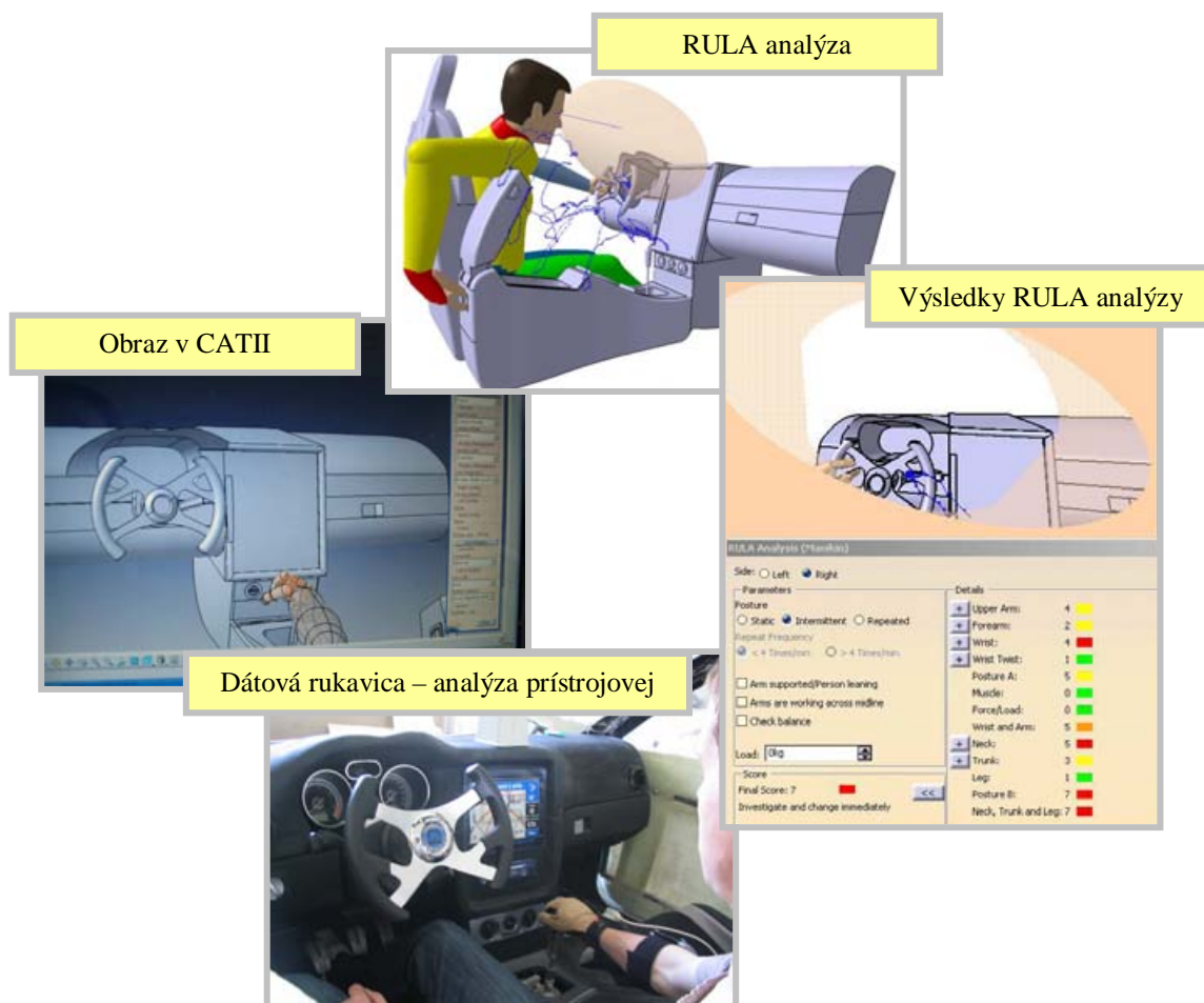
Obr. 5.11 Aplikácia dátovej rukavice CyberGlove II od firmy Immersion Corporation [55]
