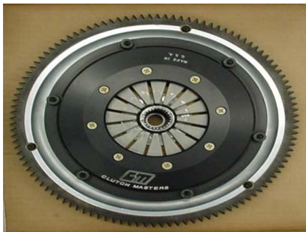
Obr. 38 Zotrvačník s ozubeným vencom
