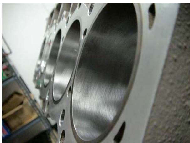
Obr.22 Vložené valce v bloku motora
