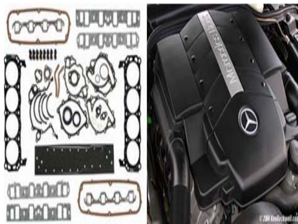
Obr. 24 Rôzne druhy tesnení a kryt motora značky Mercedes
