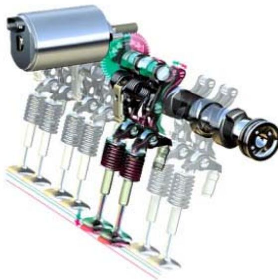
Obr. 18 Mechanicky plne variabilný systém rozvodu Valvetronic, BMW
