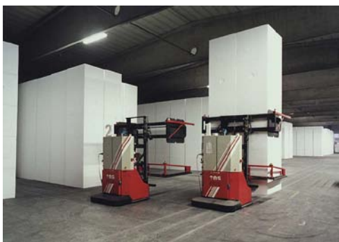
Vozidlo firmy TMS Automotion GmbH, Linz Rakúsko so špeciálnym zverákovým chápadlom podľa http://de.wikipedia.org/w/index.php?title=Datei:FTF_mit_Klammergreifer.JPG&filetimestamp=20060714172546
