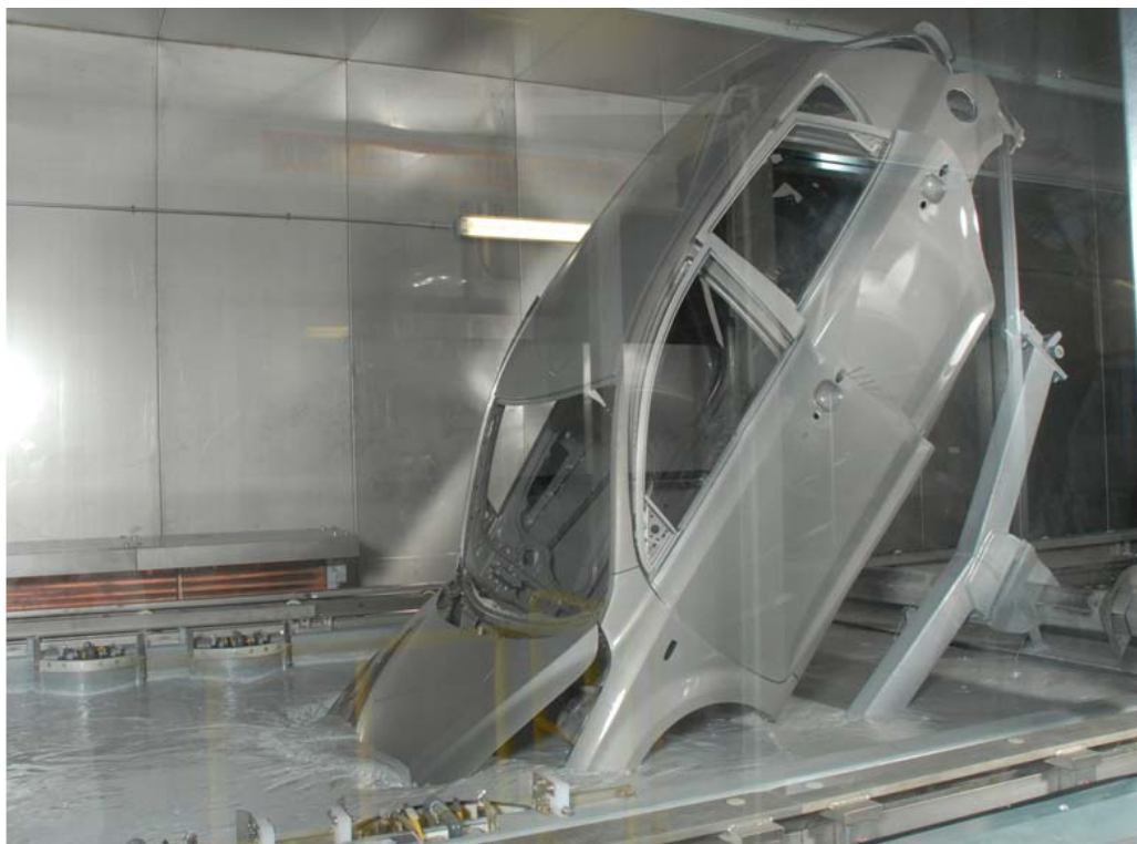
Obr. 115 Ponáranie – nanášanie základného laku
