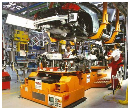
AVG systém na pracovisku „svadby“ pre športové vozidlá podľa www.tms-automotion.com
