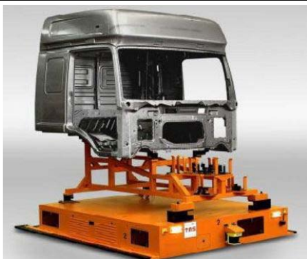
AVG vozidlo pre transport kabíny vodiča podľa www.tms-automotion.com
