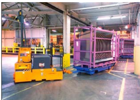
Aplikácia laserom navádzaného automatického ťahača firmy FMC Technologies vo firme Ford podľa http://www.fmcsvcs.com
