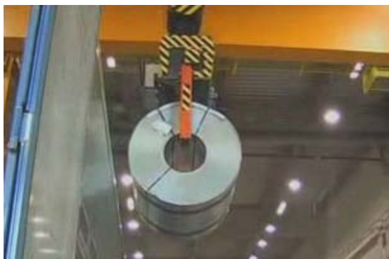
Obr. 101 Preprava zvitku žeriavom
