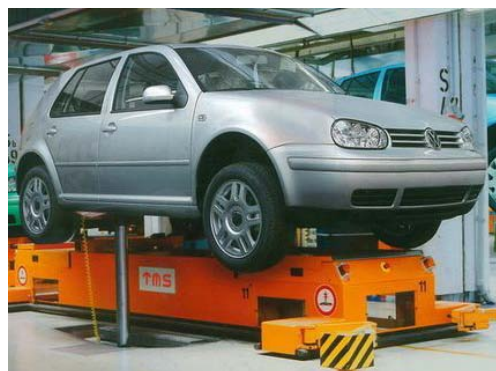
Aplikácia AVG transportného systému pri finalizácii automobilov podľa www.tms-automotion.com
