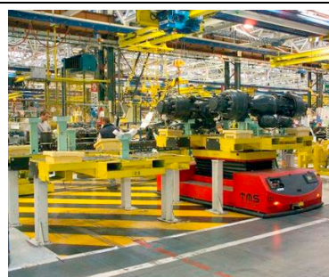
Zásobovanie montážnej linky pomocou AVG vozidiel podľa www.tms-automotion.com
