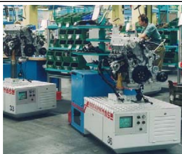
AVG pri montáži motorov podľa www.tms-automotion.com
