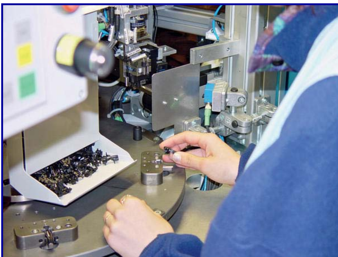
Obr. 88 Individuálne ručné montážne pracovisko [24]
