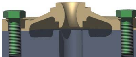
Obr. 43 Príklad stredenia súčiastky
