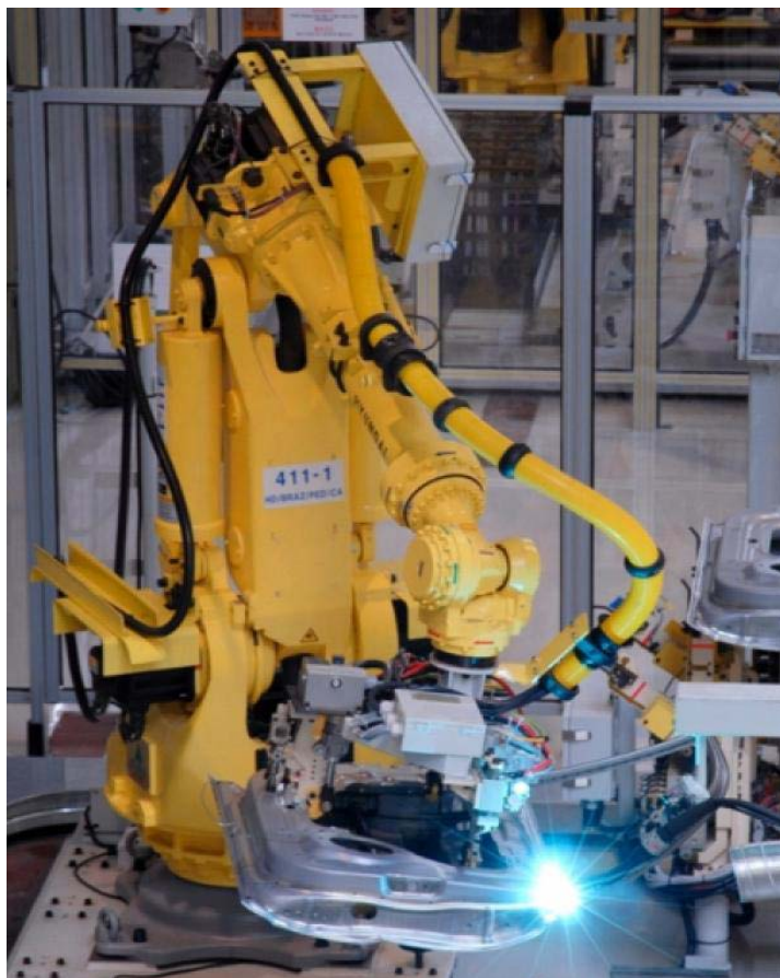
Obr. 111 Zváranie predných dverí
