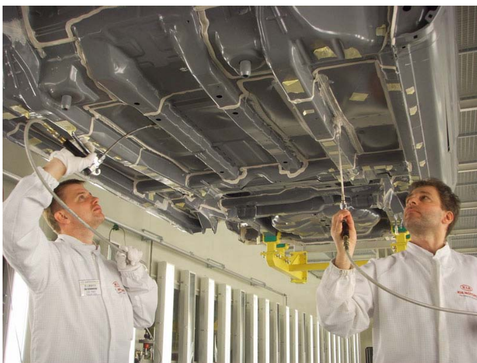
Obr. 116 Nanášanie tmelu na spodnú časť karosérie
